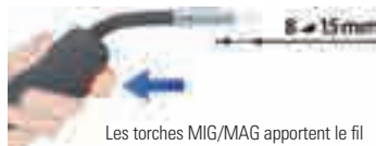
Les torches MIG/MAG apportent le fil et activent le procédé de soudage.
