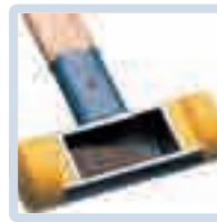
Les embouts se changent à l'aide d'un étau
